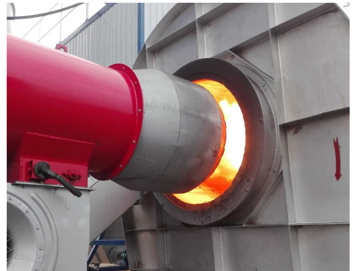
采用耐热钢制作的燃烧室
